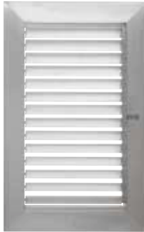
Vista AM Der Neue mit beweglichen Lamellen 50/7/0.8 mm. Seitlich im Lamellenfeld integrierte Zugstange
