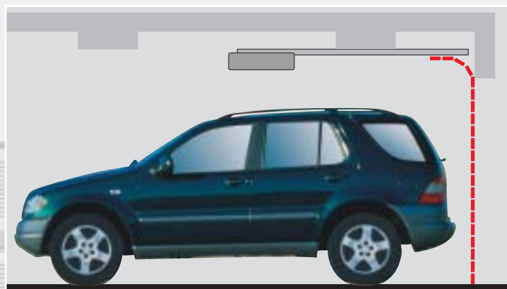
Ausgleichsblende für Niedrigsturz: 65 mm
